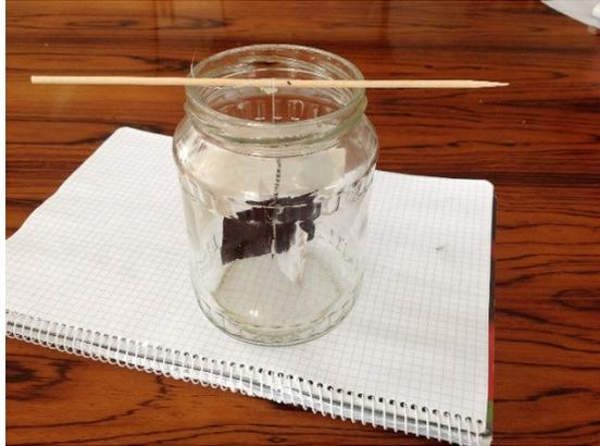
Der letzte Schritt ist, die „Mühle“ in die Sonne zu stellen. Durch die schwarzen Vierecke, da die Farbe schwarz die Wärme besser aufnimmt, entsteht ein spürbarer Wärmeunterschied zwischen den Vierecken. Dadurch fängt die „Mühle“ an sich zu drehen.
