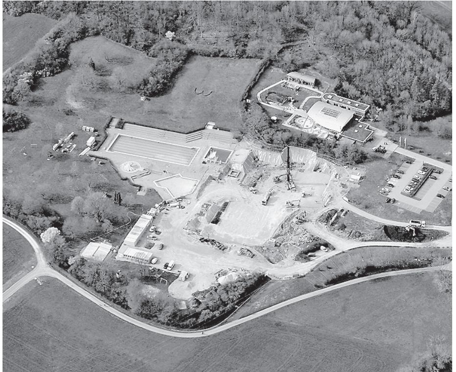
**354 Pfähle wurden im Zuge der Fundamentarbeiten ins Erdreich gebohrt und tragen künftig die 2.150 qm große Bodenplatte sowie das neue Hallenbadgebäude wie auf „Stelzen“.**
